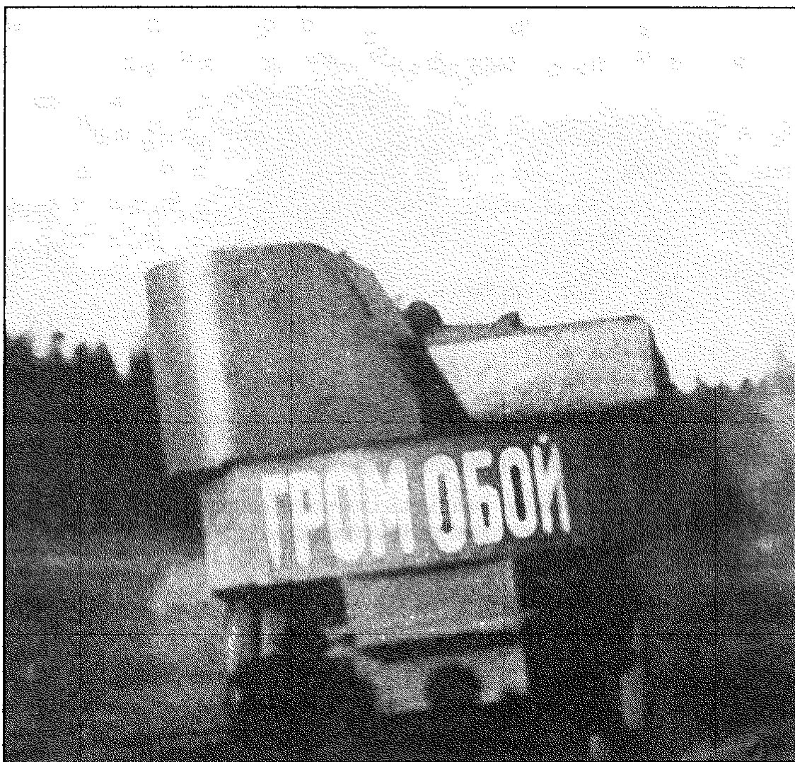
«Громобой» во время стрельбы. На фото хорошо виден перекос машины при выстреле на борт. Офицерская стрелковая школа, весна 1915 года (АСКМ).
