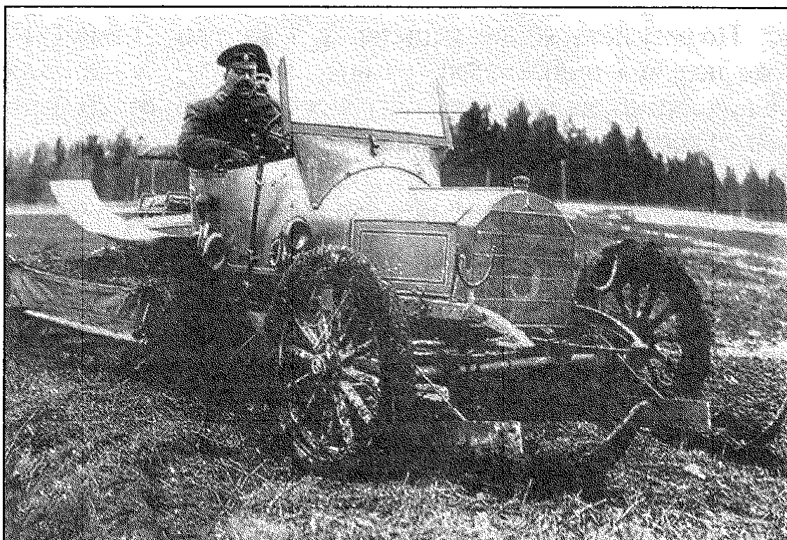
Испытания автомобиля «Мерседес» с двигателем Кегресса. 1912 год. За рулем князь В. Орлов (РГАКФД).
