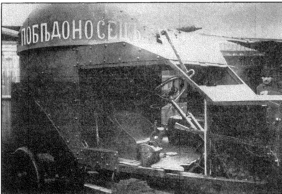
Броневик «Победоносец» во время постройки. Хорошо видно внутреннее устройство машины (АСКМ).
