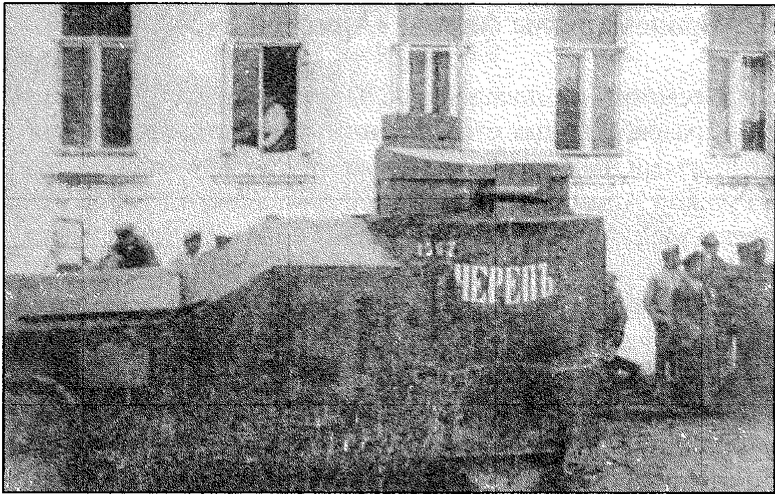
Бронеавтомобиль «Череп» на шасси «Изотта-Фраскини» после ремонта в Саратове. Весна 1919 года (РГАКФД).
