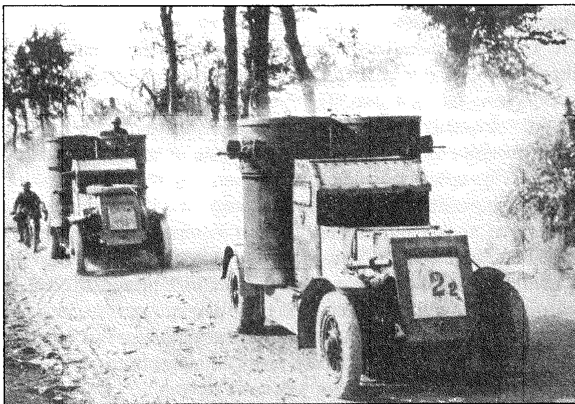
Броневики «Остин» 4-й серии 17-го батальона Королевского танкового корпуса на Западном фронте. Лето 1918 года. Хорошо видно, что машины вооружены пулеметами «Гочкис» и имеют сдвоенные задние колеса (фото из архива Я. Магнуского).
