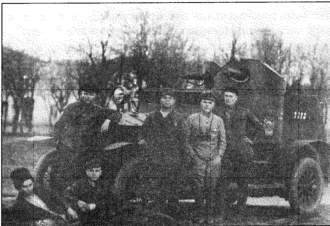
«Шеффилд-Симплекс» одного из автобронепоезд Красной Армии. 1919 год. Машина имеет переделанную бронезащиту радиатора и другую заднюю ось (АСКМ).
