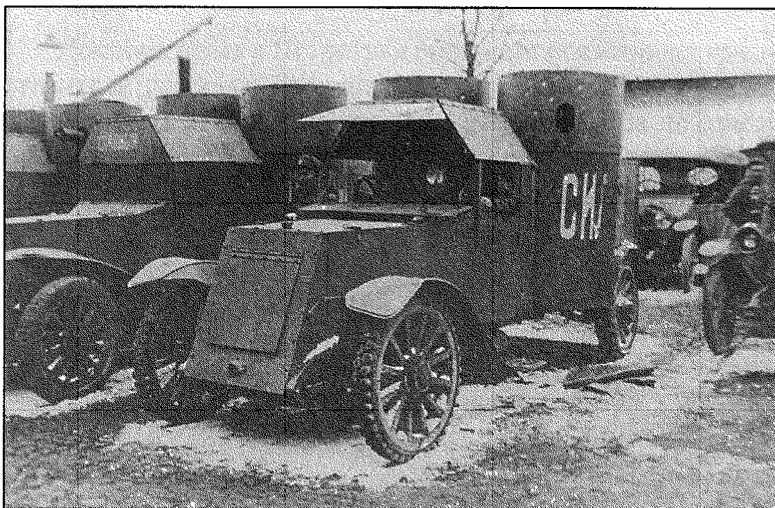
Броневик «Сильный» 8-го автопулеметного взвода после боя в Ломже. 25 февраля 1915 года. На башне, защищенной 7 мм броней, видны вмятины от пуль, 4-мм подбашенные основания в пробоинах (ЦМВС).
