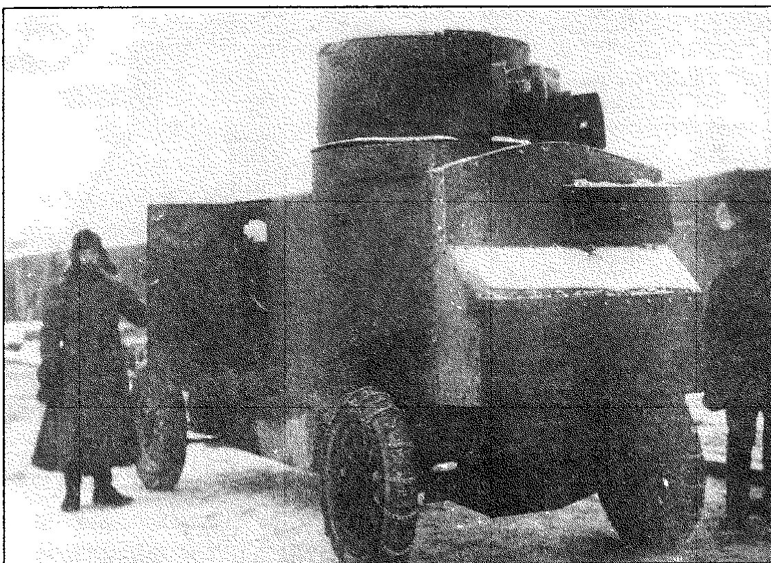
Броневи́к «Остин» русской бронировки, изготовленный Ижорским заводом по чертежам Путиловского. Зима 1920 года (АСКМ).
