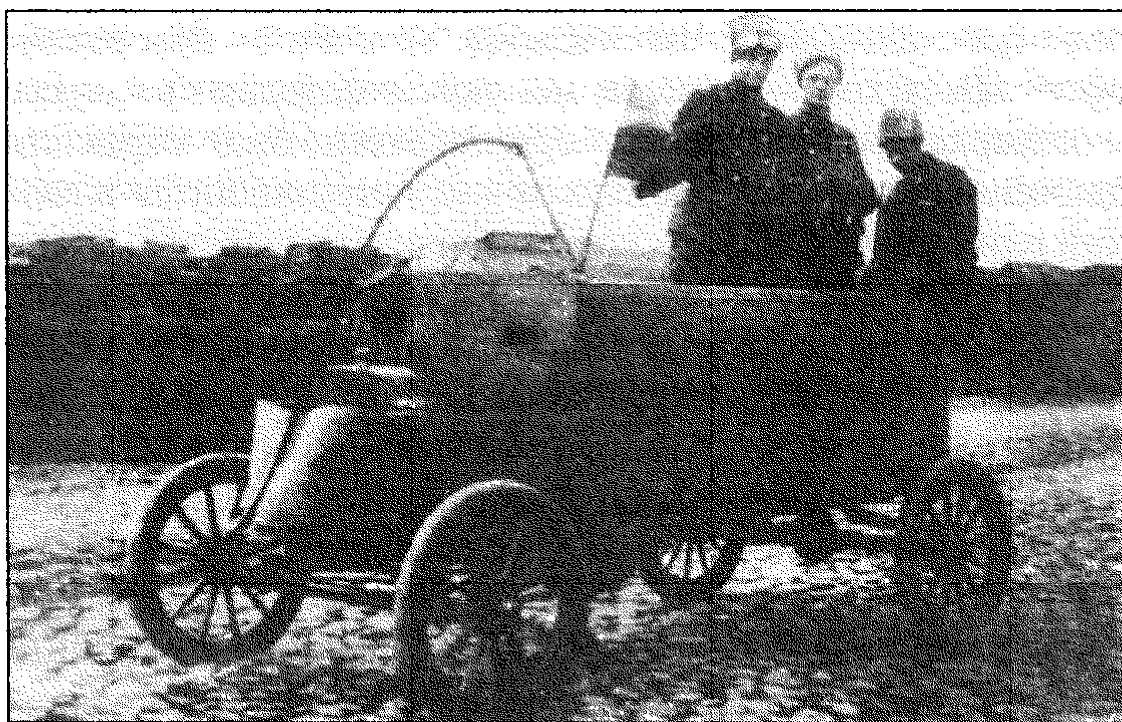
Автомобиль «Форд-Т» с корпусом из «железной брони» на испытаниях. 1915 год (РГВИА).
