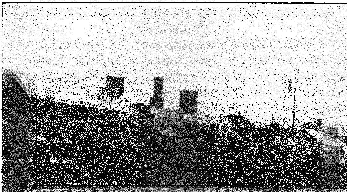
Бронепоезд 2-го Сибирского железнодорожного батальона. 1916 год. Хорошо видна конструкция передней бронеплощадки и бронепаровоз по типу бепо «Хунхуз» (АСКМ).
