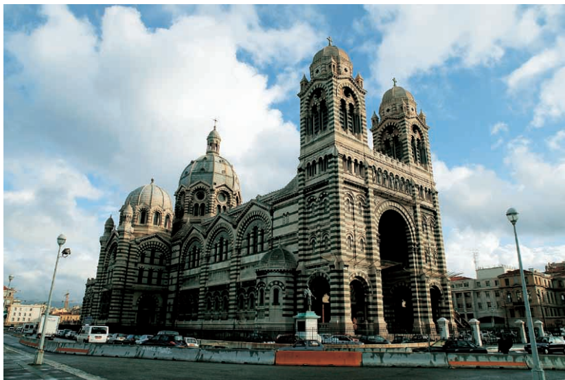
Фотография того же здания, что и на верхнем снимке, без использования сдвига. Вследствие значительной широкоугольной перспективы здание на фотографии сужается кверху.
