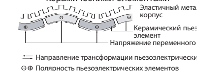
Рис. 42. Схема расположения пьезоэлектрических керамических элементов (в основании статора)
