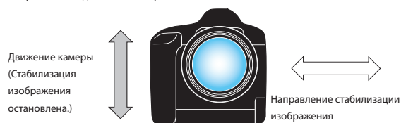
Рис. 56. Схема процесса работы системы Image Stabilizer (стабилизатор изображения)
