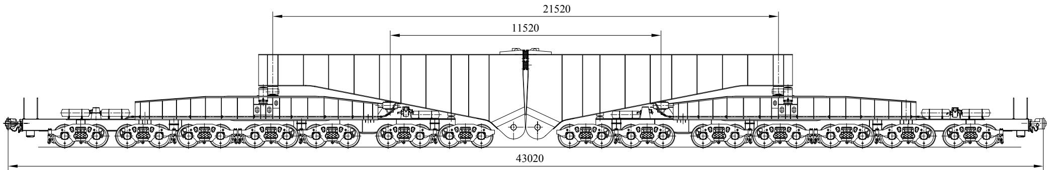
Предназначен для перевозки энергетического и другого оборудования.
