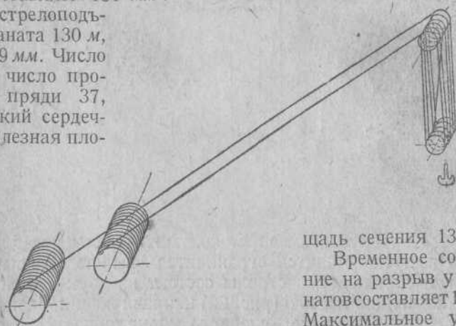
Рис. 24. Схема установки каната для подъема груза
