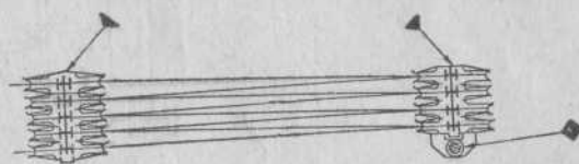
Рис. 60. Схема смазки полиспада стрелы
