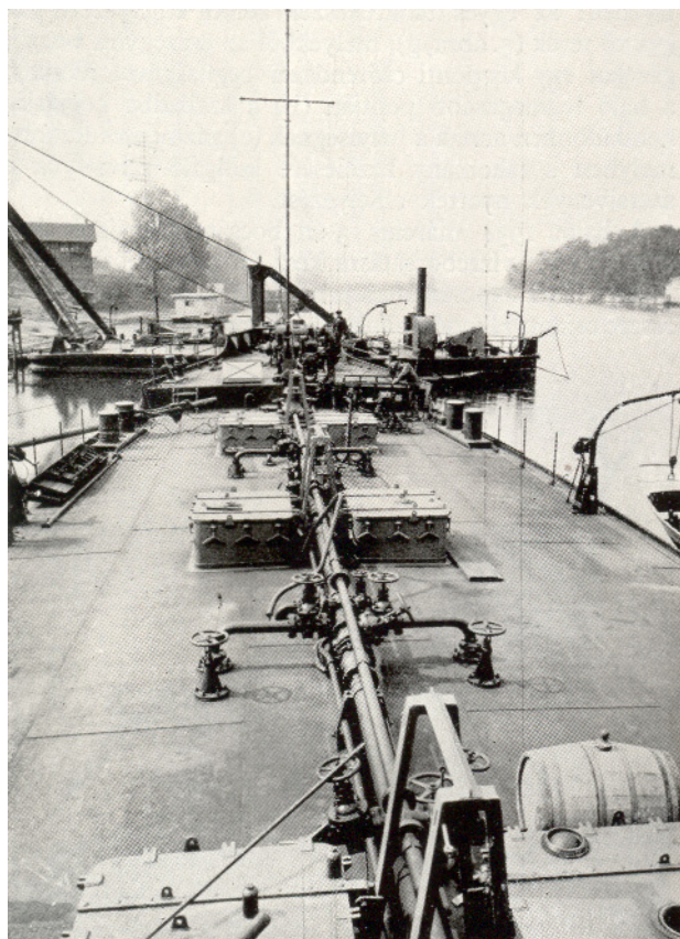
8. ábra. Csővezetékek elrendezése. – Anordnung der Rohrleitungen. – Arrangement of piping. – Disposition des tuyauteries.
