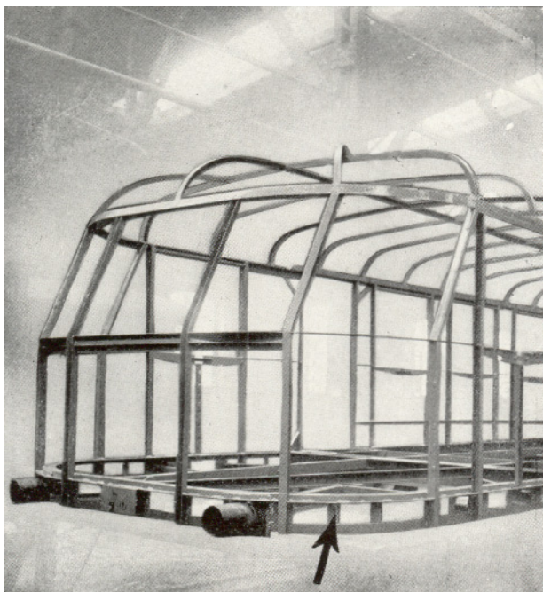
A nyíllal jelölt behegesztett lemezdarabok a könnyű hossztartók alsó és felső övét kötik össze.
