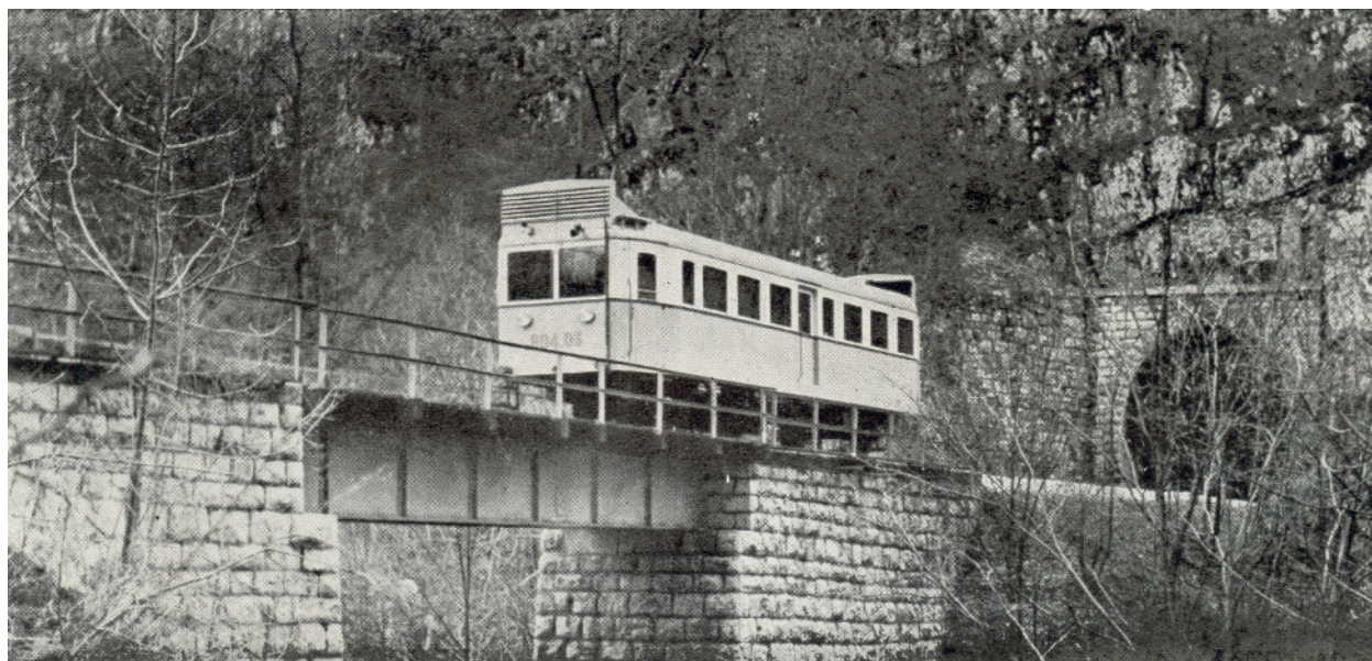
63. ábra. Könnyű kivitelű, kéttengelyű motorkocsi a veszprém–győri vonal zirci szakaszán.
