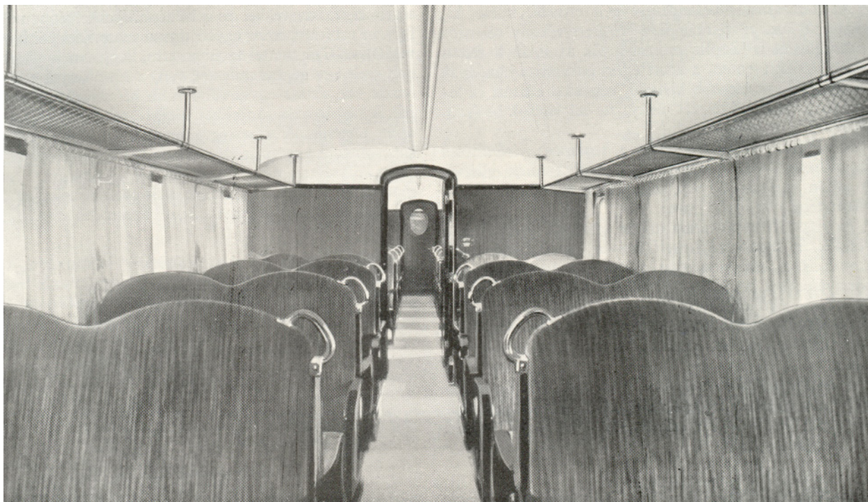
103. ábra. A négytengelyű sínautóbusz belseje. Az ülőhelyek száma, a párnázott csapóüléseket beszámítva: 72.
