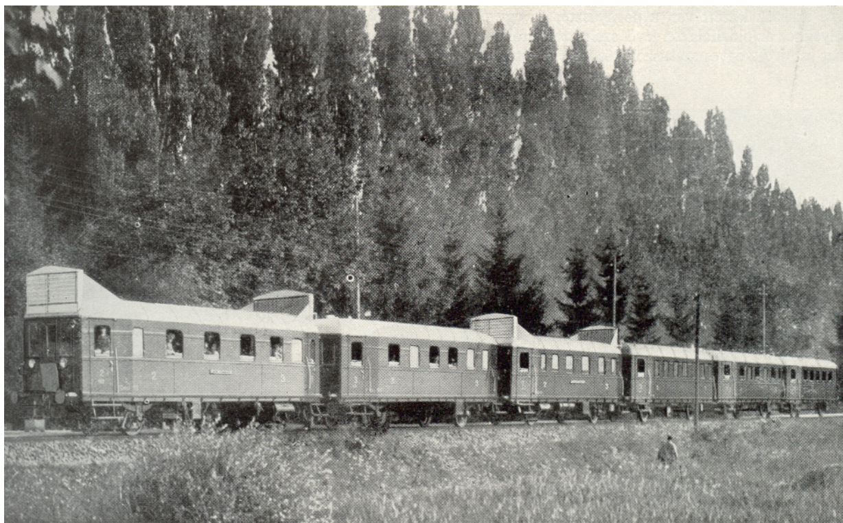
62. ábra. Két kéttengelyű Dieselmotorkocsiból és négy pótkocsiból álló motorvonat.
